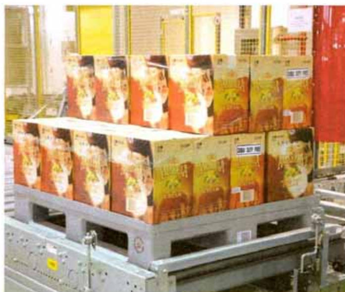
Pour limiter les risques d'incidents dans son entrepôt automatisé, l'aéroport de Dubaï s'est entièrement équipé de palettes en plastique.
