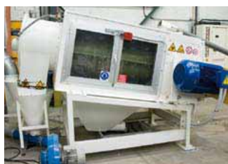
Séparation des poussières et séchage
