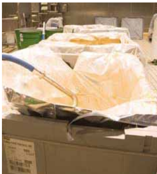
La purée de fruits est aspirée hors du Combo en vue du conditionnement final
